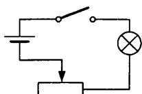
Соберите электрическую цепь по схеме (рис. 44). Расположите ползунок переменного резистора в среднем положении. С помощью резистора измените яркость свечения лампы. Понаблюдайте предметы, окружающие лампу, через щель экрана.
